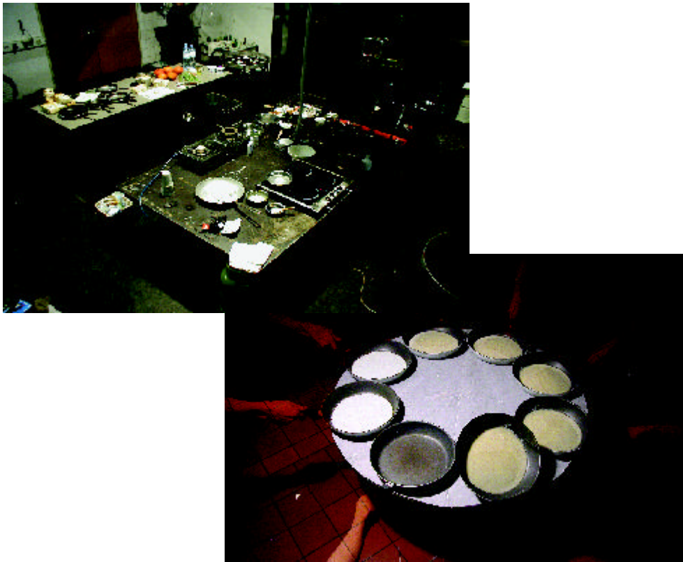
Eine erste Versuchsanordnung für die Palatschinkenmaschine. Acht Teflon-beschichtete Pfannen bilden das erste Pfannenkarussell. Die Pfanne unten links wirft die auf einer Seite gerade fertig gewordene Palatschinke aus.
